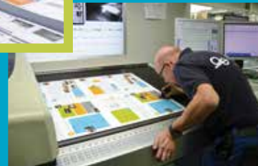
Rechts: ein Techniker prüft die Farbgebung mit Hilfe einer Messlupe.
